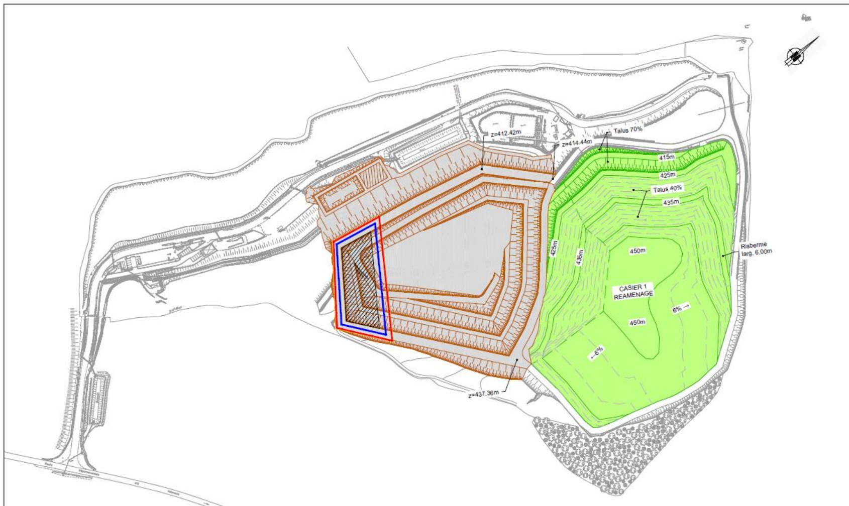
Figure 10 : Cartographie des zones d'effets d'un incendie sur la zone d'exploitation, vue à grande échelle
